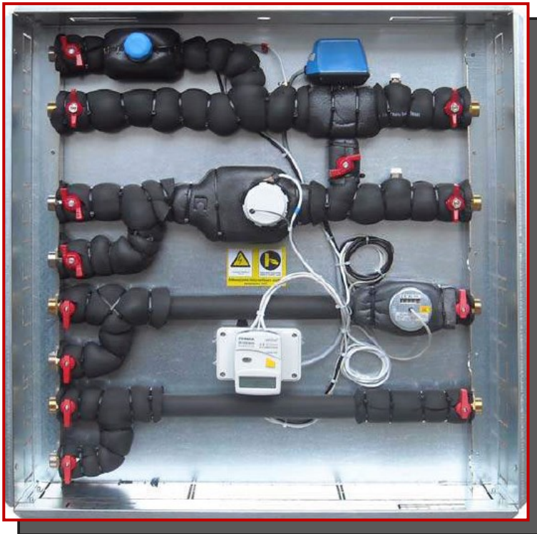
MODULO DI CONTABILIZZAZIONE CON COMMUTAZIONE STAGIONALE ESTATE / INVERNO E DOPPIA PARTENZA PER ACQUA SANITARIA INTERAMENTE COIBENTATO
