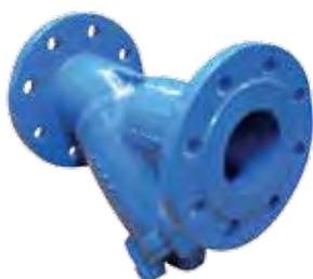
Filtro a Y con spurgo flangiato PN 16 - corpo in ghisa GJL500 Pressione massima di esercizio: PN16. Temperatura massima di esercizio: -10°C + 120°C Flangia: UNI - EN 1092.
