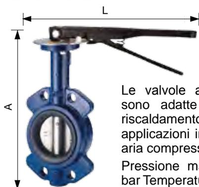
Le valvole a farfalla tipo Wafer sono adatte per impianti idrici, riscaldamento, condizionamento, applicazioni industriali ed agricole, aria compressa. Pressione massima di esercizio 16 bar Temperatura massima di esercizio -10°C + 120°C
