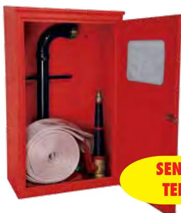
Cassetta in acciaio zincato SP 10/10, verniciata con polveri epossidiche per esterno rosso RAL 3000, corredata di collo di cigno Dn 70 con uno sbocco UNI 70, lancia a 3 effetti UNI 70 modello "MISTRAL", manichetta UNI 70 a norma UNI 9492 con raccordi UNI 804 e legature UNI 7422.
