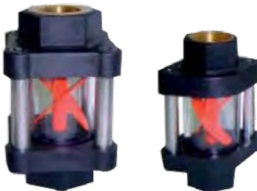
Accessorio per il dispositivo di ANTI-SURRISCALDAMENTO per le pompe antincendio UNI EN 12845 e UNI 10779 Permette il controllo visivo del passaggio del liquido per le pompe antincendio in funzione e con la mandata chiusa. L'elica è colorata e migliora la visualizzazione anche con liquidi opachi. L'indicatore è equipaggiato di un tubo visore in vetro naturale.
