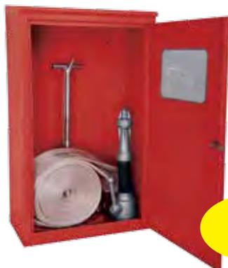
Cassetta in acciaio zincato SP 10/10, verniciata con polveri epossidiche per esterno rosso RAL 3000, corredata di: chiave telescopica, lancia UNI 70 a 3 effetti, manichetta UNI 70 a norma UNI 9492 con raccordi UNI 804 e legature UNI 7422
