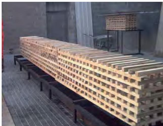
Caratteristiche dei focolari di prova di classe "A" secondo **UNI EN 3-7**.
