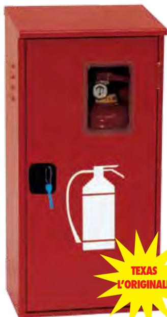
I modelli "S" sono forniti con sigillo di sicurezza numerato. In caso di emergenza il sigillo si rompe con uno strappo. L'apertura sulla porta (protetta da lastra trasparente) permette di effettuare i controlli di sorveglianza previsti dalla norma UNI 9994 -1 di manutenzione relativa agli estintori.
