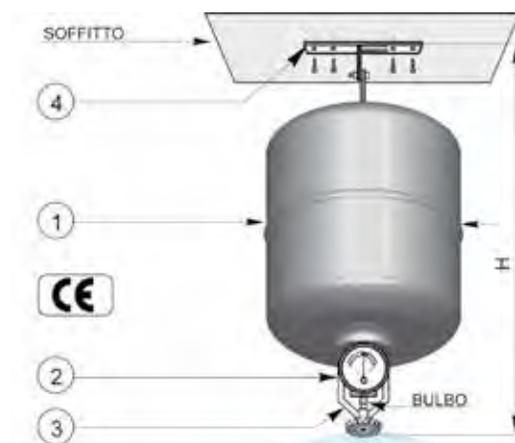
Per una corretta installazione occorre considerare che il dispositivo automatico posto ad una altezza di tre metri offre una copertura di spegnimento pari a circa 9÷12 metri quadrati di superficie.
