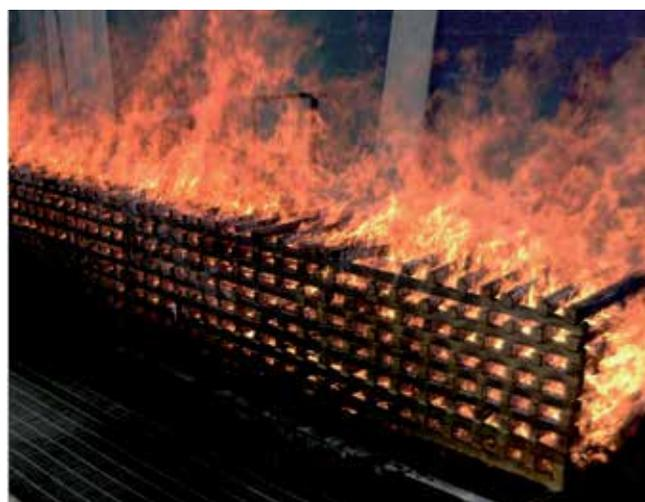
Vista frontale di un focolare tipo (identica per tutti i tipi di focolari)
