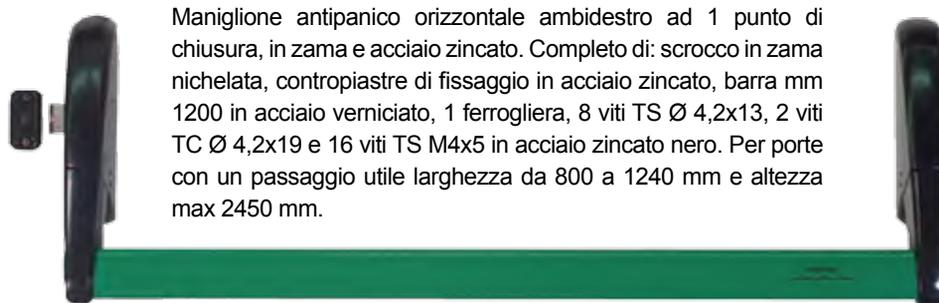
Maniglione antipanico orizzontale ambidestro ad 1 punto di chiusura, in zama e acciaio zincato. Completo di: scrocco in zama nichelata, contropiastre di fissaggio in acciaio zincato, barra mm 1200 in acciaio verniciato, 1 ferrogliera, 8 viti TS Ø 4,2x13, 2 viti TC Ø 4,2x19 e 16 viti TS M4x5 in acciaio zincato nero. Per porte con un passaggio utile larghezza da 800 a 1240 mm e altezza max 2450 mm.
