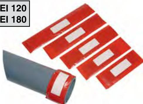
Fasce flessibili con materiale intumescente di alta prestazione incapsulato in una busta di polietilene per fasciare tubazioni plastiche per attraversamenti di pareti e pavimentazioni. La fascia esposta al calore del fuoco espande rapidamente riempiendo il tubo in plastica che collassa fino a sigillare completamente l'apertura.
