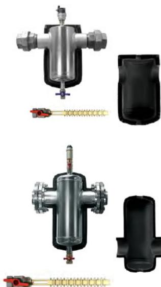
Costruiti in acciaio al carbonio UNI 7091/72 con finitura zincata a freddo, trattengono fanghi ed impurità solide e permettono di scaricare l'aria in eccesso presente negli impianti di riscaldamento tramite il rubinetto di spurgo e la valvola di scarico aria.
