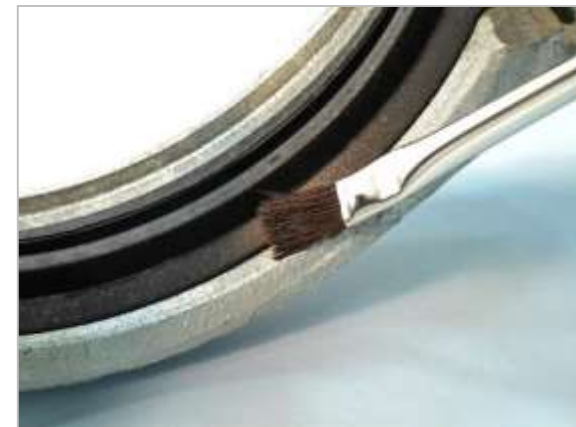
3. Lubrificare la guarnizione
