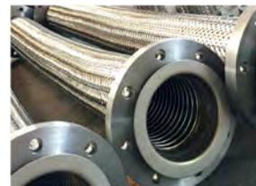
Tubi flessibili metallici corrugati in **acciaio inox** , trafilati con o senza saldatura longitudinale. Vengono prodotti da macchine speciali le quali, meccanicamente o idraulicamente, formano delle onde che possono essere parallele o elicoidali a seconda dell'applicazione dei flessibili.
